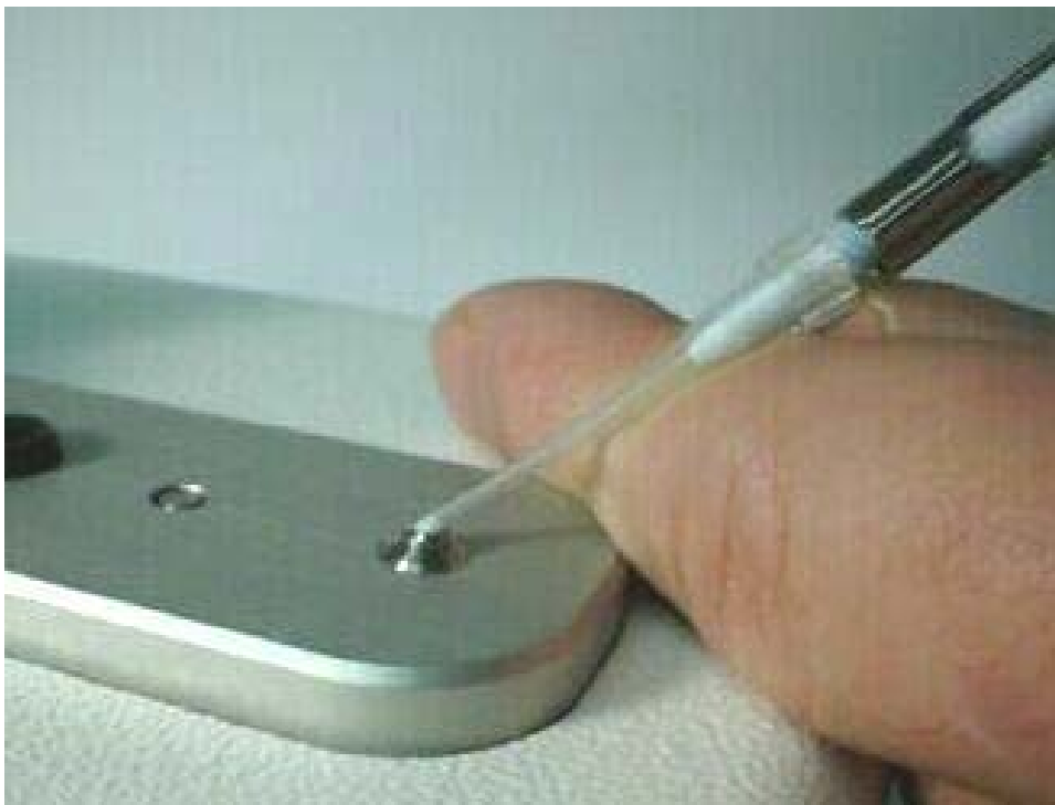
Rys. 2. Nakładanie próbki na podstawę pomiarową NanoDropa (zbliżenie)
