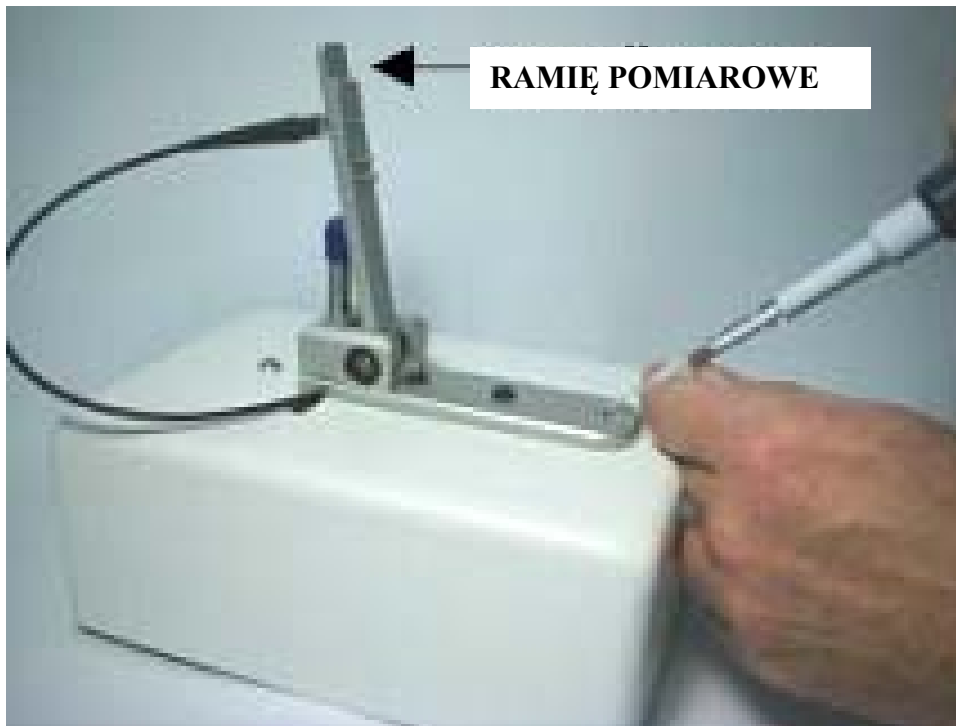
Rys. 2. Nakładanie próbki na podstawę pomiarową NanoDropa (zbliżenie)
